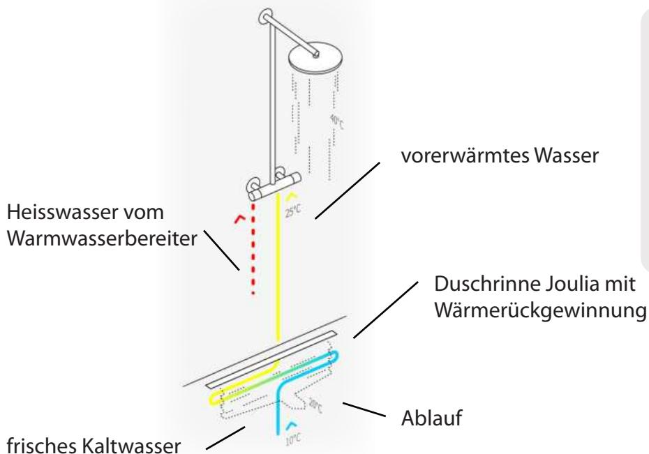
Das warme Abwasser der Dusche läuft über einen Wärmetauscher, durch den das kalte Frischwasser fließt. Dadurch wird das Wasser vorerwärm, so dass weniger Heißwasser benötigt wird, um die zum Duschen gewünschte Temperatur einzustellen
